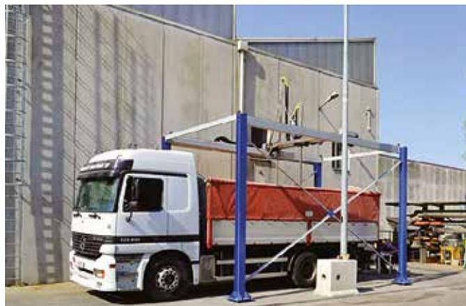
Основное отличие модели СТОРК 440 Рельс (одна опора) от модели СТОРК 440 Компакт — рельсовая конструкция на двух опорах, расположенная параллельно борту грузовика. Отбор пробы производится со всей площади кузова автотранспортного средства (с прицепом или полуприцепом) без его перемещения.
