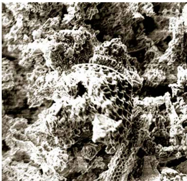
Рис. 2. Фотография микроструктуры сорбента Заслон® под электронным микроскопом
